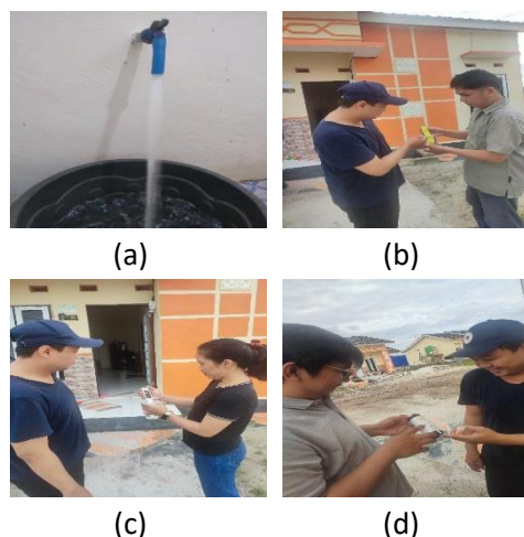
Gambar 3. Proses sampling dan Analisis Sampel Air Sumur. (a) sumber air sumur, (b) pengujian sampel air sumur dengan pH meter, (c) pengujian sampel air dengan menggunakan TDS meter, dan (d) pengujian parameter kimia pada sampel air dengan menggunakan strip test
