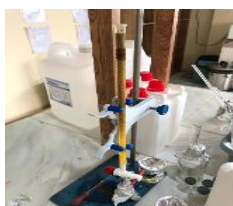
Gambar 8. Proses kromatografi kolom (pemisahan)
